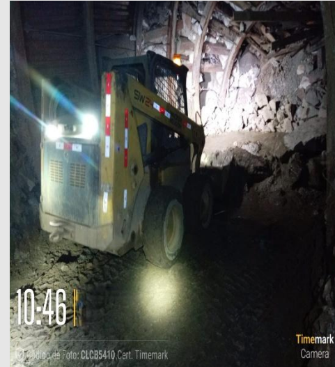
LIMPIEZA CON MINICARGADOR SECCION 2.0 x 2.0 M
