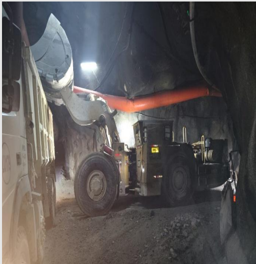
CARGUIO DE MATERIAL CON SCOOPTRAM
