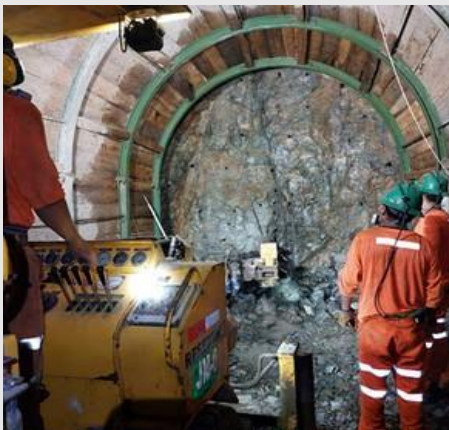
AVANCE – JUMBO SECCION DE 3.5 M X 3.5 M
